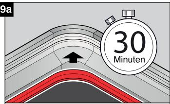
Falls die Dichtung beschädigt wurde muss diese getauscht werden, warten Sie bitte bis der Kleber ausgehärtet ist (ca. 30 min.) und folgen Sie den Anweisungen der Austauschanweisung für die Dichtung (Seite 2-3, Schritt 1-11)
