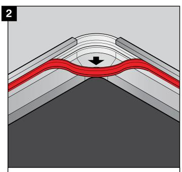
Ziehen Sie die Dichtung raus damit sie nicht beschädigt oder beim Tausch des Abdeckbogen eingeklemmt wird.
