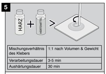
Verwenden Sie chemisch resistente Schutzbrillen und Handschuhe beim Verarbeiten des Klebers. Mischen Sie den Zweikomponentenkleber Harz (R) und Härtemittel (G) in gleichgroßen Teilen auf einer geeigneten Unterlage bis eine gleichmäßige graue Farbe erreicht ist.
