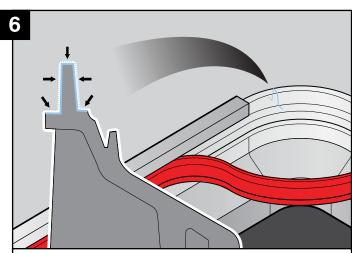
Nach dem Mischen tragen Sie die Klebemasse unverzüglich auf die horizontalen und vertikalen Flächen der Haupteckverbindung auf.
