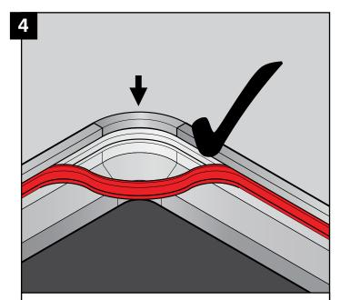
Testen Sie ob der Abdeckbogen korrekt passt und keine Blockierungen bestehen.
