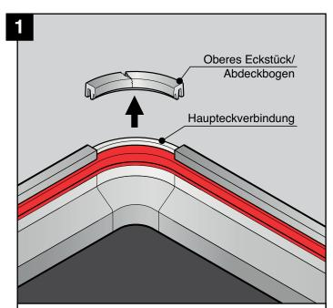
Entfernen Sie den beschädigten Abdeckbogen. Bitte beachten Sie, dass dabei die Dichtung nicht beschädigt wird, da dies sonst die Wasserdichtigkeit beeinflussen kann. Falls die Dichtung beschädigt ist, muss diese getauscht werden. Siehe hierzu Austauschanweisung (Seite 1, Schritt 1-6), fahren Sie dann mit Schritt 3 fort.
