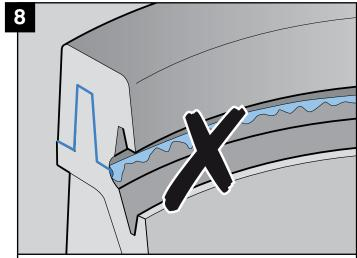
Entfernen Sie überschüssige Kleberrückstände, auch in der Aushöhlung für die Dichtung da dies den Sitz der Dichtung beeinträchtigen kann.
