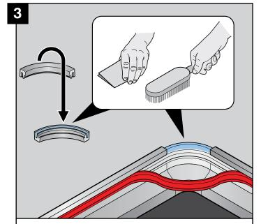
Reinigen Sie Klebe-Kontaktflächen der Eckverbindungen gründlich (KEINE LÖSUNGSMITTEL VERWENDEN) um Fremdkörper oder Kleberrückstände zu entfernen. Benutzen Sie dafür eine Drahtbürste oder Schleifpapier. Entfernen Sie danach Staubreste mit einem sauberen, trockenen Tuch.
