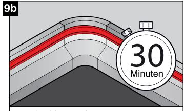
Wenn der Kleber ausgehärtet ist (ca. 30 min) drücken Sie die Dichtung in die dafür vorgesehene Aushöhlung.
